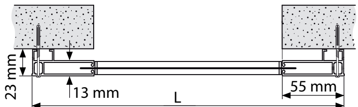
Coulisses d'occultation façade
